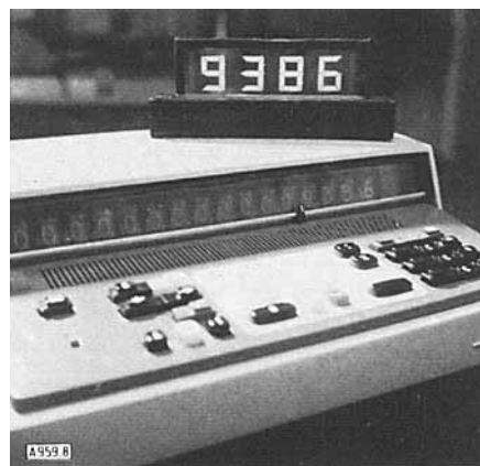
Abb. 8. Beispiel für eine Flüssigkristall-Anzeigevorrichtung nach dem Prinzip der dynamischen Streuung.
